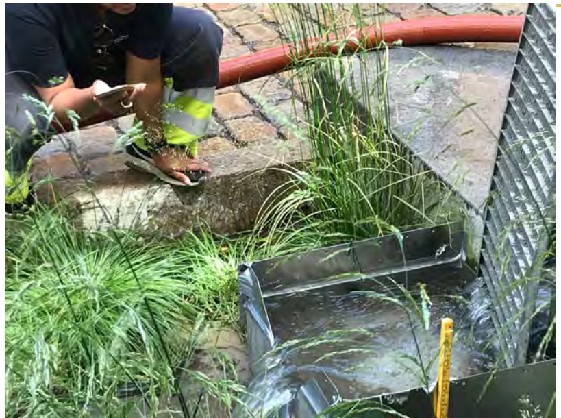
Testing av regnbedene i Deichmans gate viste at terskelementet ved innløpet ikke var dypt nok til å lede tiltenkte overvannsmengder til bedet. Testingen avdekket også at jordoverflaten i et av regnbedene var anlagt skjevt slik at vannet gikk i overløp over kanten lenge før det prosjekterte fordrøyningsvolumet var fylt opp. Foto: Nevedda Sivakumar og Gerd Minde.
