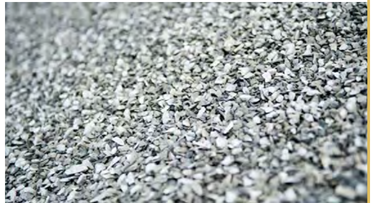
Maskinsand er kantete og inneholder mer finstoff enn natursand. Infiltrasjonsevnen blir derfor dårlig ved bruk i regnbed. Foto fra Herremyr Gård.
